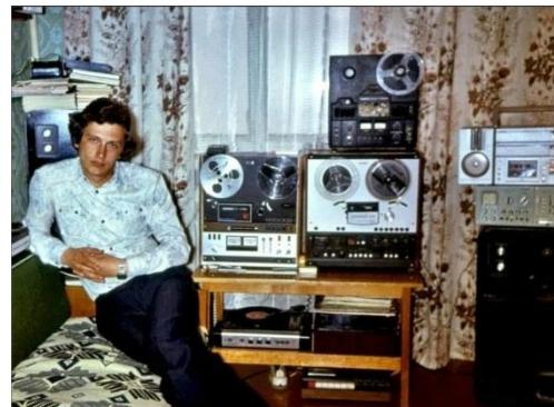
**Магнитофон** (от магнит и греч. φωνή звук) — электромеханическое устройство, предназначенное для записи звуковой информации на магнитные носители и/или её воспроизведения. В качестве носителя используются материалы с магнитными свойствами: магнитная лента, проволока, магнитные манжеты, диски, барабаны (<https://ru.wikipedia.org/wiki/%D0%9C%D0%BD%D0%BF%D0%BB%D0%BE%D0%BD%D0%BA%D0%BE%D0%BC>)
